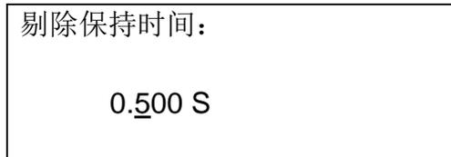
按[左]<、[右]>键，可将光标移到要调整的数字位置；按[上]∧，[下]∨键，可调整光标位置的上的数字。剔除保持时间调整完成后，按[确认]键，即可保存剔除保持时间参数并返回到[产品参数]画面。
